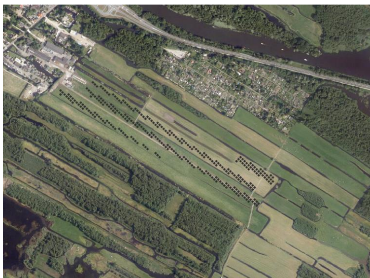
Afbeelding 3.3 Zeer grove indicatie van de met bouw- en sloopmateriaal opgehoogde percelen (schetsweergave op basis van kaartmateriaal uit [ref 5])
