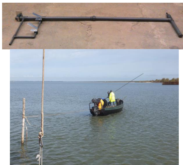
Figuur B.7 Boven, geassembleerd buizenstelsel (links het onderwatergedeelte), onder de meetpaal na plaatsen.
