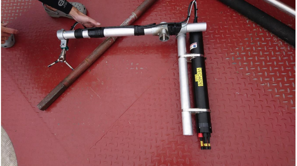
Figuur B.8 ADV met batterijhuis op het meetframe.
