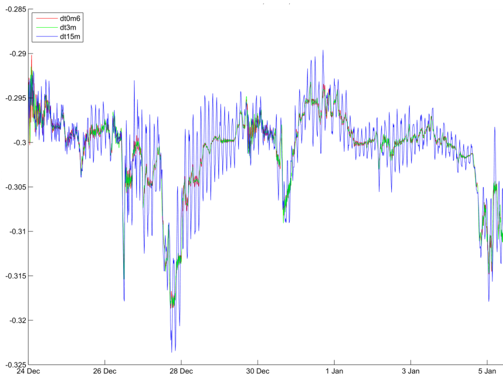
Figuur C.6 Voorbeeld voor observatiestation E van gebruikte modelresultaten voor waterstand (in meters t.o.v. NAP) voor nagaan van de benodigde rekestijdstap voor Delft3D-FLOW in slibmodel voor waterbeweging.
