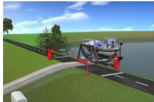
Figuur 4.10 Illustraties mogelijke oplossingen overtoom (bron linker afbeelding: Van der Marel, 2017, bron rechter afbeelding: Waterrecreatieadvies BV)
